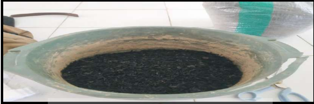
Gambar 3.3 Potongan Ban Berserat Nilon
